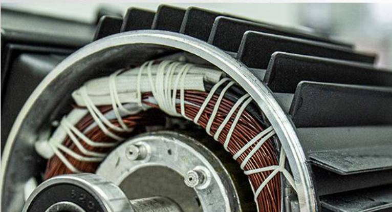
Carcasa motorului din aliaj de aluminiu
