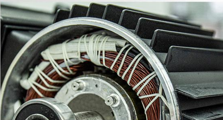
Carcasa motorului din aliaj de aluminiu
