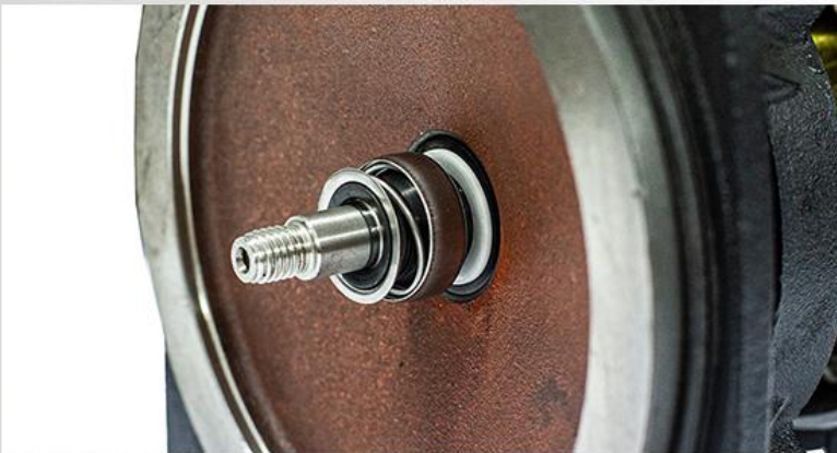
Garnitura mecanică: ceramică/grafit/NBR
