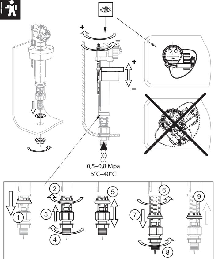
**ČZ MONTÁŽ A NASTAVENÍ:** Ventil musí být instalován ve svislé poloze, přitažen ke stěně WC nádržky maticí N023 (N039). Výška hladiny vody v nádrži se nastavuje výškou polohy plováku N107 pomocí polohovacího šroubu N085. V přítokové části tělesa ventilu je vsunuto plastové sítko N125 na zachycení případných nečistot ve vodě. Pro snadné vyjmutí je sítko opatřeno stopkou. Montážní závit ventilu G1/2" (G3/8") je uzpůsoben pro běžný způsob připojení k vodovodnímu řádu.
